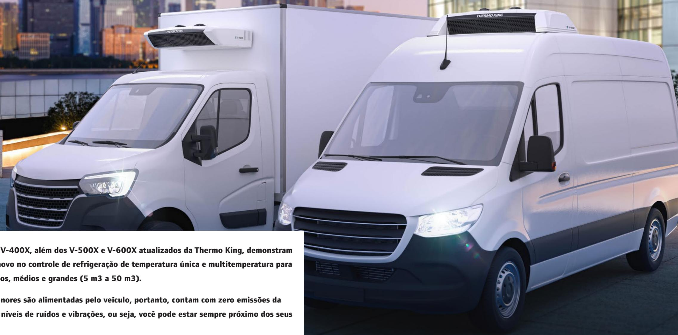
**Os novos modelos V-400X, além dos V-500X e V-600X atualizados da Thermo King, demonstram o que há de mais novo no controle de refrigeração de temperatura única e multitemperatura para caminhões pequenos, médios e grandes (5 m<sup>3</sup> a 50 m<sup>3</sup>).**
