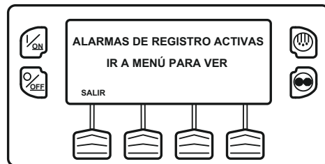
Figura 101: Existen alarmas de registro
